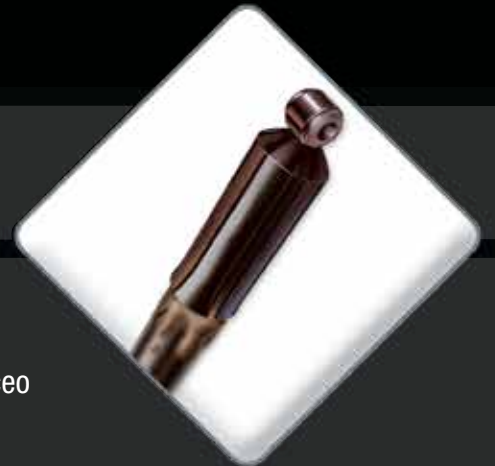
Si presenta fugas Reemplazar
