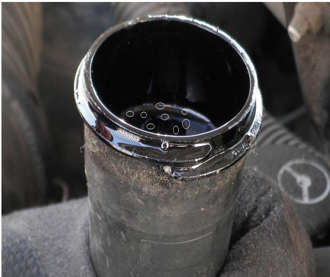
Paso #7. El aire será expulsado por el depósito del líquido, cuando dejen de aparecer burbujas deje de bombear el cilindro esclavo.
