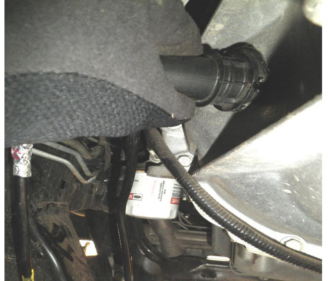
Paso #8. Coloque debidamente su cilindro esclavo en la transmisión, y pruebe su sistema de embrague.
