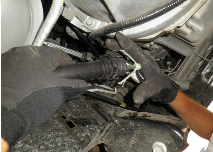
Paso #5. Suelte el vástago y déjelo salir totalmente.
