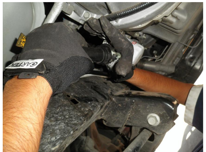
Paso #4. No instale el cilindro esclavo colóquelo en posición horizontal y presiónelo hasta el fondo.
