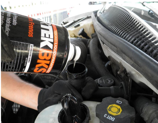
Paso #3. Ponga a nivel el líquido. Le recomendamos utilizar líquido de frenos CARTEK
