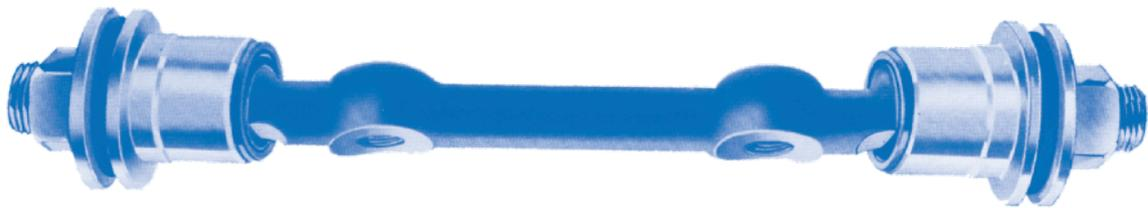
Muchos vehículos carecen de un ajuste de cámbor adecuado. Al instalar una flecha Moog Excéntrica nos da un incremento aproximadamente de 1 1/2 grados más de ajuste. Esto tiende a reducir el desgaste de la llanta y restaura la conducción.
